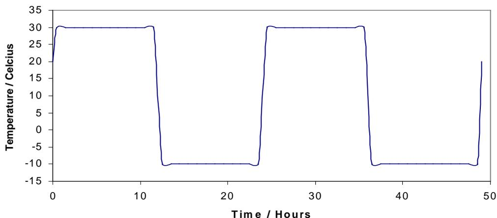
**RESULTS OF ENVIRONMENTAL TESTS ON SO<sub>2</sub> CYLINDERS**
